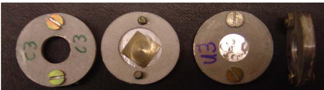
**Abb. 4.2** Probenhalter als 3-teilige Kapsel aus Reinaluminium mit Al-Folie (in der Mitte ist die Werkstoffprobe zu erkennen).
