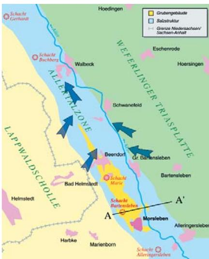
**Abb. 1:** Geologische Struktur und Grundwasserabstrom im Bereich des Endlagers (Salzformation unterirdisch: hellblau, Schacht: gelb)
