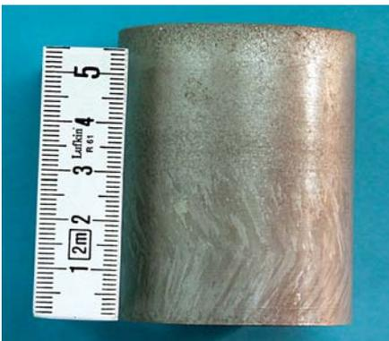
Abb. 3: Demonstration des direkten Magnetfeldinflusses auf die Struktur: die kolumnaren Dendriten wachsen auf die Strömung zu - eine Umpolung des Magnetfeldes bewirkt deshalb eine veränderte Ausrichtung der Kristalle -. Nimmt die Intensität der Strömung weiter zu, beobachtet man den Umschlag hin zum globulitischen Wachstum
