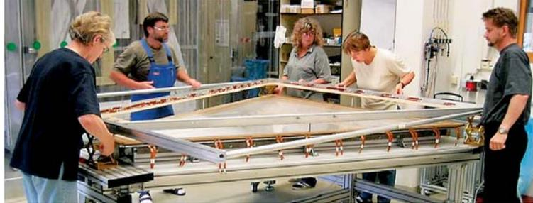
Magneten vermessen große, mit Gas gefüllte Detektoren, so genannte Vieldrahtkammern, die Flugbahnen der Teilchen mit hoher Genauigkeit, die schließlich die Energie des  $e^+e^-$ -Paares bestimmen.
