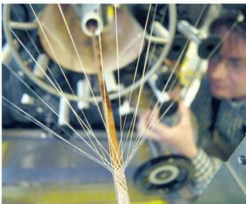
Detailaufnahme der Spulenwickelmaschine, mit der die Pulsfeldspulen gewickelt und die Drähte, wie hier zu sehen, mit hochfesten Fasern umflochten werden.
