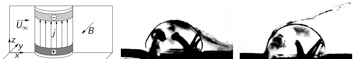
Abb. 3.7: Kontrolle der Strömungsablösung an einem Halbzylinder. Skizze des Aufbaus (links) und Visualisierungen in der x - y -Ebene von Lielausis (1961) mit Lorentzkraft stromab (Mitte) und stromauf (rechts). In den Originalbildern vorhandene Winkelmarkierungen wurden entfernt.
