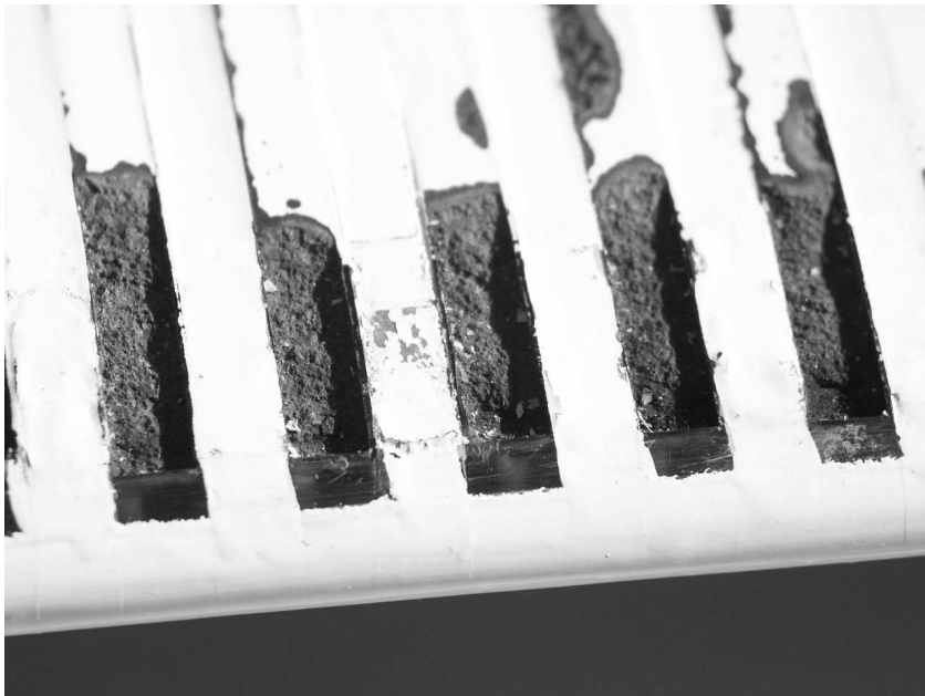
Abb. B.2: Teilansicht des PTL IV S mit stark angegriffenen Elektroden. Vergrößerte Darstellung im Maßstab ca. 2:1.
