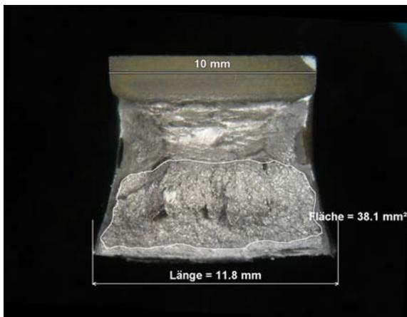
Bild 47: Probe 2 bei T = -40°C geprüft
