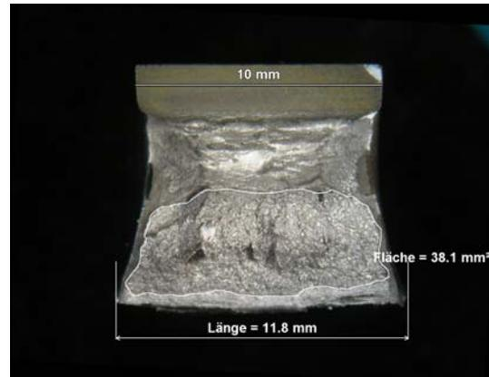
Bild 10 : lichtmikroskopische Auswertung einer Bruchfläche
