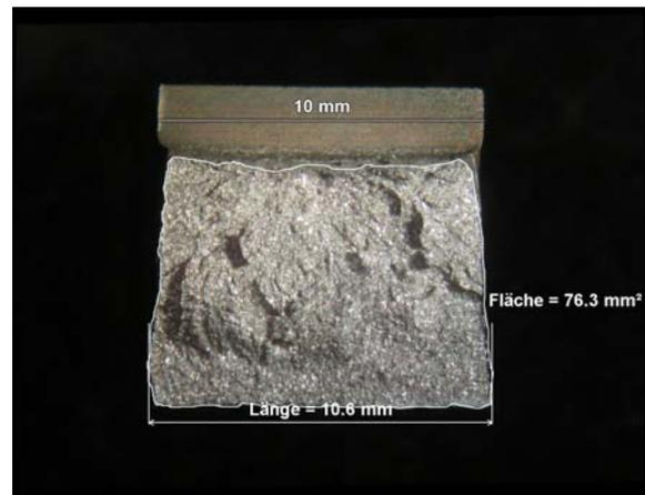
Bild 46: Probe 22 bei T = -60°C geprüft
