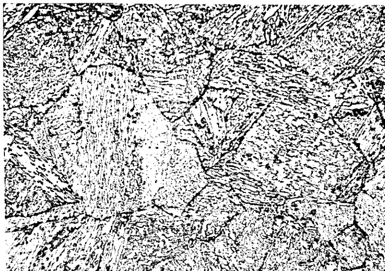
Abb. 5.2.2 Gefüge des Materials KU-1 der Lagen 0 (oben), 1/4-T (Mitte) und 1/2-T (unten), lichtmikroskopische Aufnahme, 200x
