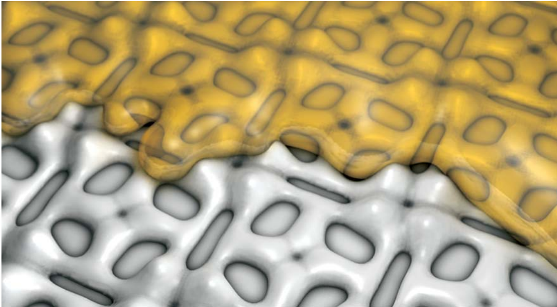
Fig. 2: 3D-Schema zur Benetzung eines S-Layers mit Metallsalzlösung
