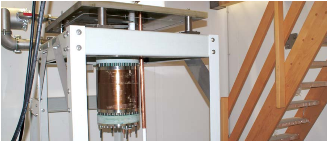
Fig. 2: Kompaktpule der dritten Serie (KS3) für Magnetfeldpulse bis über 70 Tesla in einer der fünf Pulsfeldkammern des Hochfeld-Magnetlabors Dresden.
