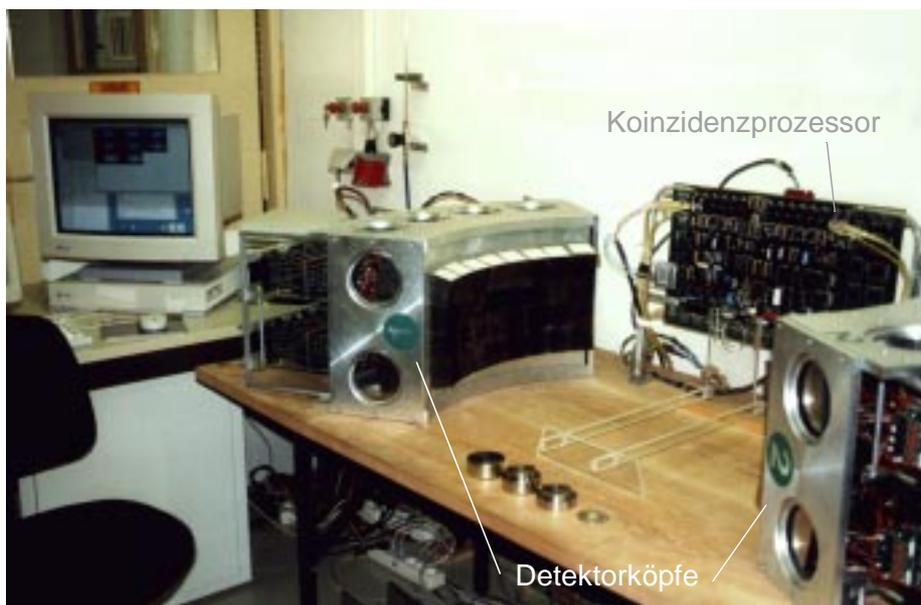
**Abbildung 3.1: Ansicht des Aufbaus des PET-Scanners im Detektorlabor, rechts im Bild die beiden Detektorköpfe und der Koinzidenzprozessor**
