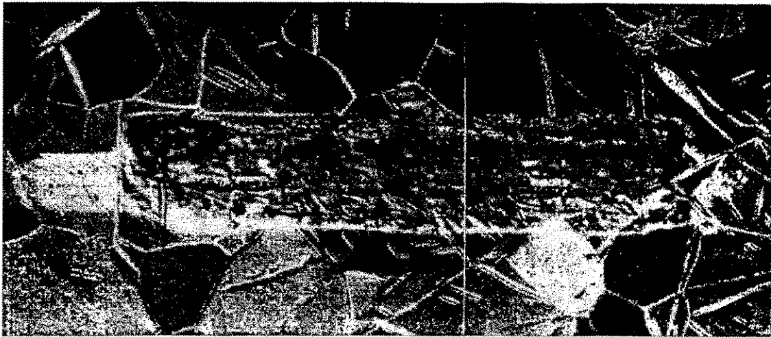
Abb. 80: Scratchspur bei einer Amplitude von 100µm und einer Last von 50mN in Probe 5 mit O-Doppelimplantation. Durch die Implantation werden die Korngrenzen hervorgehoben.
