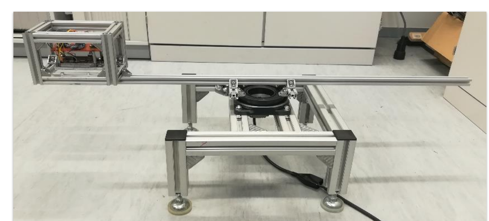
Validierung der Sensorfusion am Drehtisch im Labor
