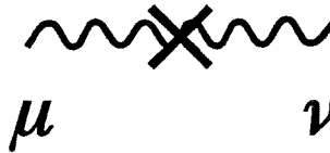
Abbildung 2.10: Die Feynmanregel dieses Gegenterms lautet: -i(Z_2 - 1)e\gamma_\mu .
