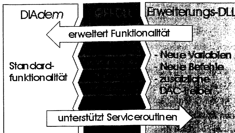
Bild 2.3: GPI-DLL – Schnittstelle zwischen DIAdem und externen Funktionen
