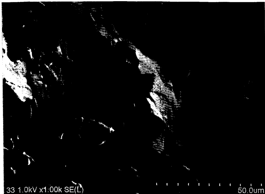
Bild 4.5.37: Detailaufnahme der Bruchfläche der hoch bestrahlten 1JFL-Probe VB33 (Prüf-T=-40°C bei T_0=-44,9^\circ\text{C} , K_{Jc_{-1T}}=138 \text{ MPa}\sqrt{\text{m}} , zensiert), transkristalliner Spaltbruch (Replika)
