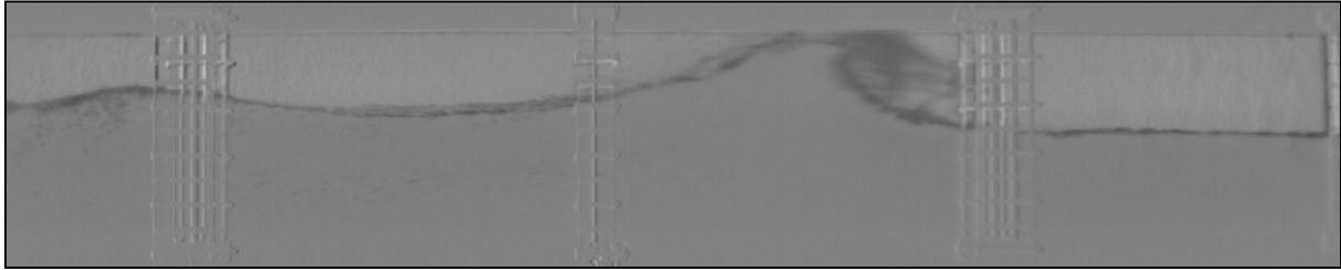
Bild 3.4: Schwallströmung (mit subtrahiertem Hintergrund)
