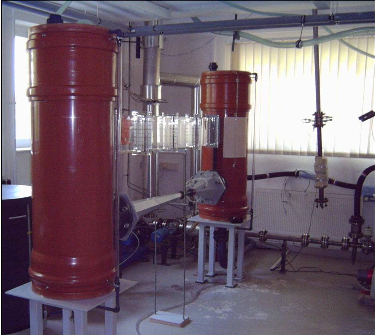
Bild 2.1: Foto des horizontalen Luft/Wasser-Strömungskanals
