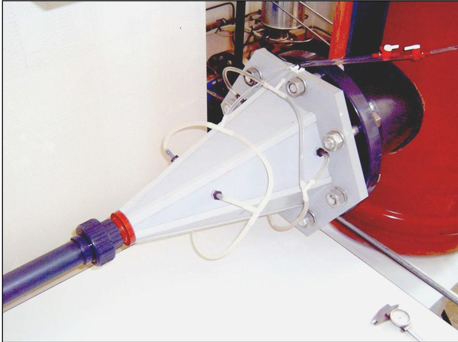
Bild 2.5: In die Versuchsanlage eingebaute Fangdüse
