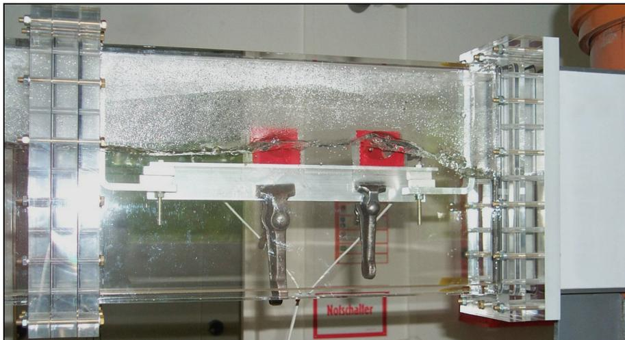
Bild 6.1: Aufbau der aufgespannten Ultraschall-Messköpfe
