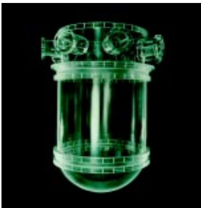
Das Reaktormodell bildet das Kernstück von ROCOM – es ist detailgetreu aus Plexiglas (1:5-Modell) gefertigt und ermöglicht auch Messungen der Strömungsgeschwindigkeit des Wassers mit optischen Methoden (Laserstrahlen).
