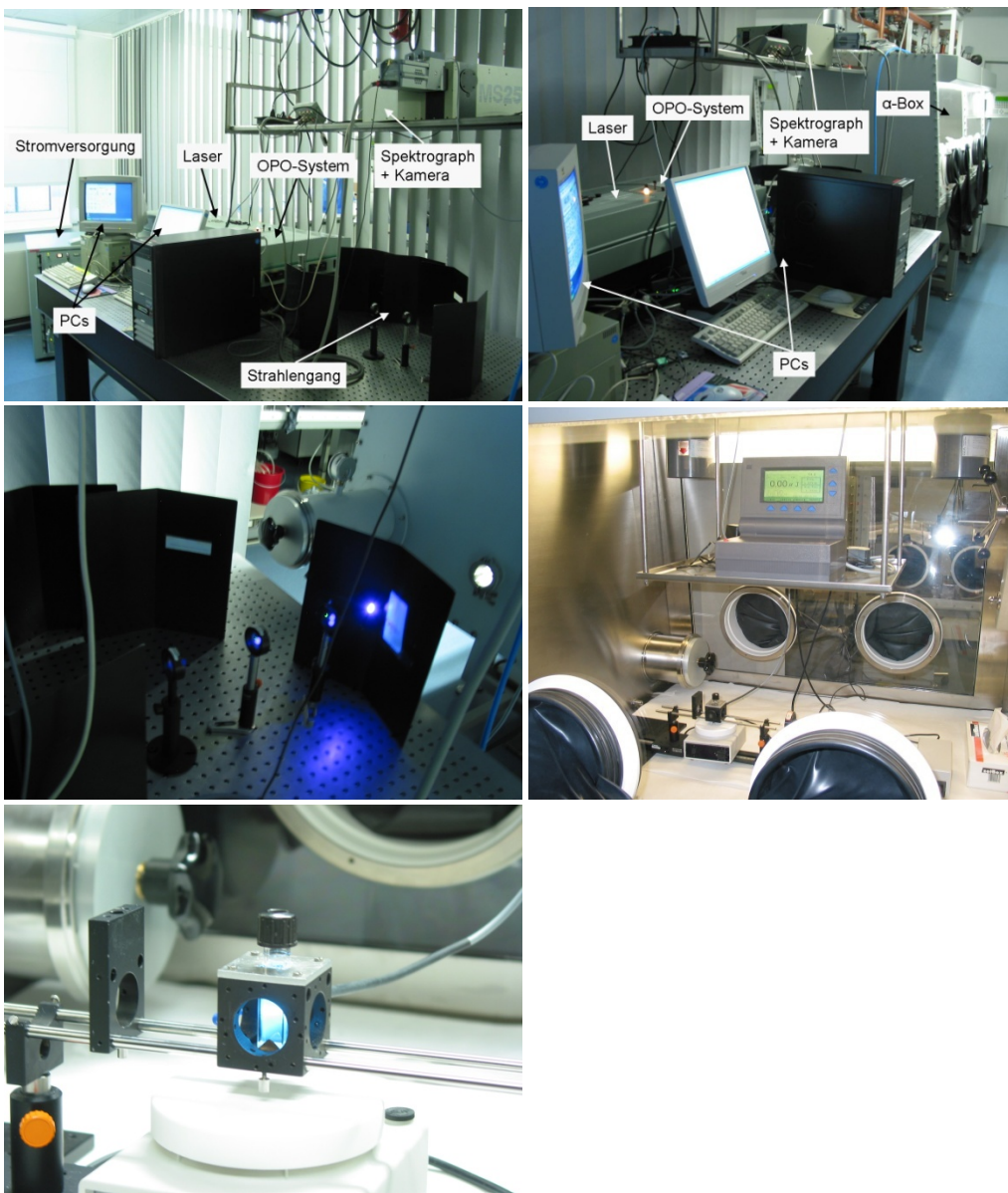
Abbildung 25: Fotos des Cm(III)/Eu(III)-TRLFS-Systems am Institut für Radiochemie des Helmholtz-Zentrums Dresden-Rossendorf (oben: apparative Anordnung; Mitte: Strahlengang (links) und Messplatz in der \alpha -Box (rechts); unten: Kuvette mit lumineszierender Cm(III)-Lösung (nicht farbgetreu))
