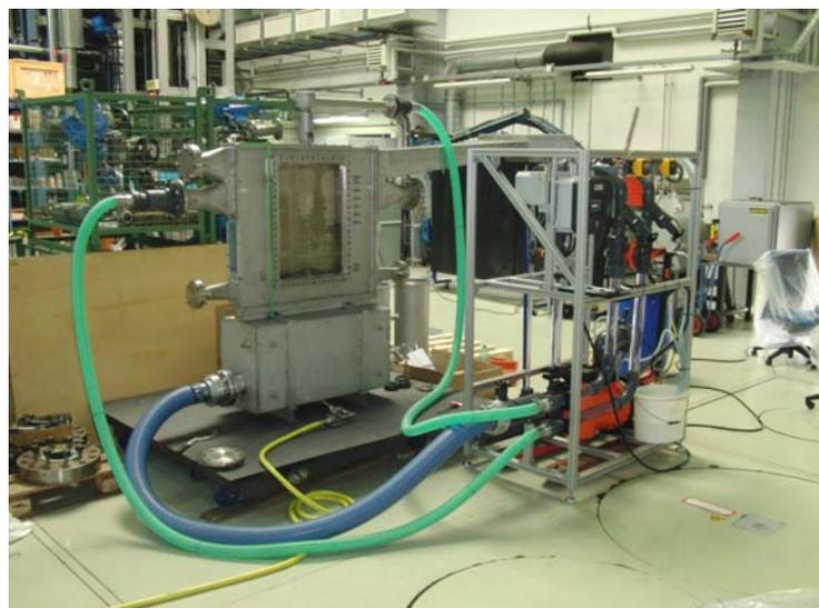
Abb. 2.48 Testbassin im Drucktank zur Ausrichtung (links) Pumpstand und Testbassin bei Wasser-Luft-Experimenten (rechts)
