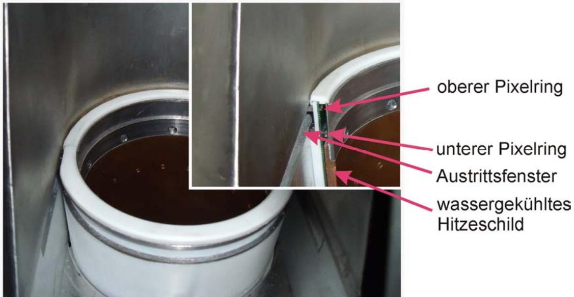
Abb. 2.39 Foto des Zweiebenendetektors mit zweimal 288 Pixeln; Scanebenen kurz unter- bzw. oberhalb der Metallringe; Abstand ca 11 mm. Durchmesser der Scanöffnung 135 mm
