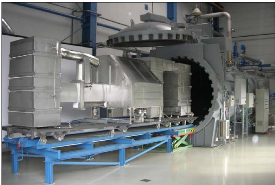
Abb. 2.41 Teststrecke Heißstrangmodell mit Isolation und Haube
