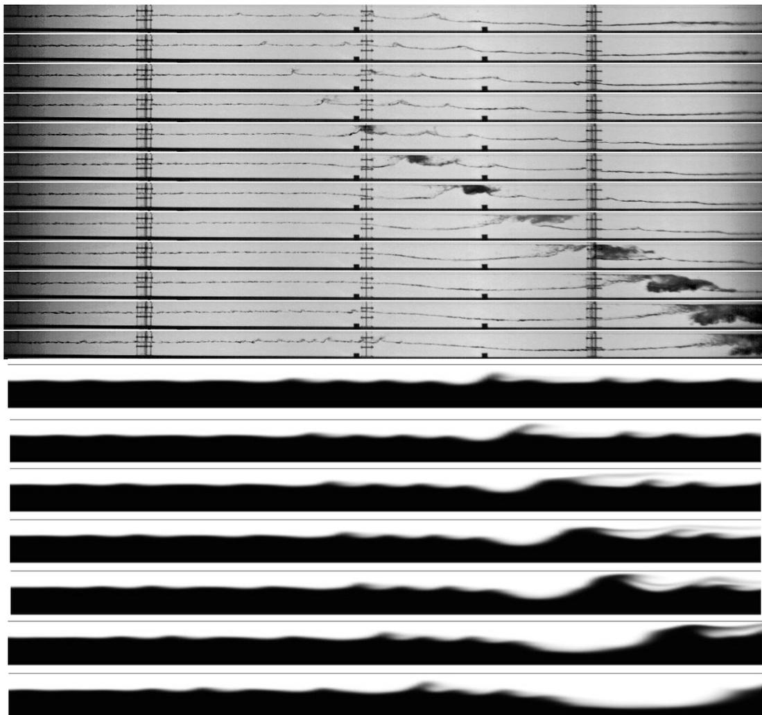
Abb. 5.48 Gemessene und berechnete Bildfolge bei  $J_L = 1,0$  m/s und  $J_G = 5,0$  m/s mit  $t = 50$  ms (abgebildeter Teil des Kanals: für der Messung 0 bis 3,2 m und für die Simulation 1,4 bis 6 m nach dem Eintritt)
