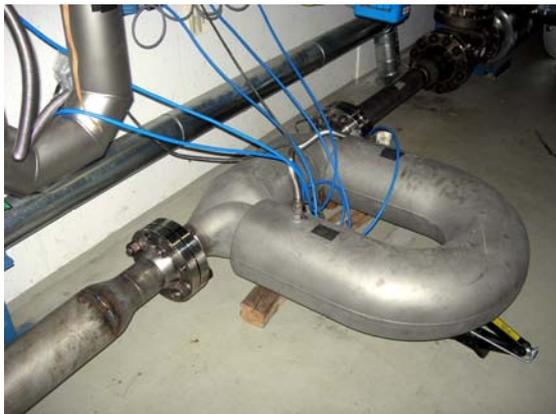
Abb. 2.8 Coriolis-Durchflussmesser während der Montage im Teststreckenkreislauf
