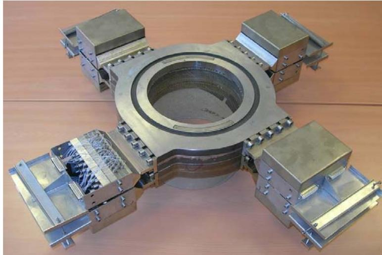
Abb. 2.14 Neue Hochdruckgittersensoren
