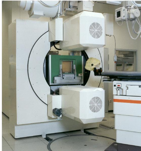
**Abbildung 2.7:** In-beam Positronenkamera BASTEI am medizinischen Bestrahlungsplatz der GSI. Mittig im Bild ist das Strahlaustrittsfenster zu sehen. Rechts befindet sich der Patiententisch mit angebrachter Maske zur Fixierung der Patienten. Ober- und unterhalb dieser Maskenhalterung befinden sich die beiden Detektorköpfe des PET-Scanners.
