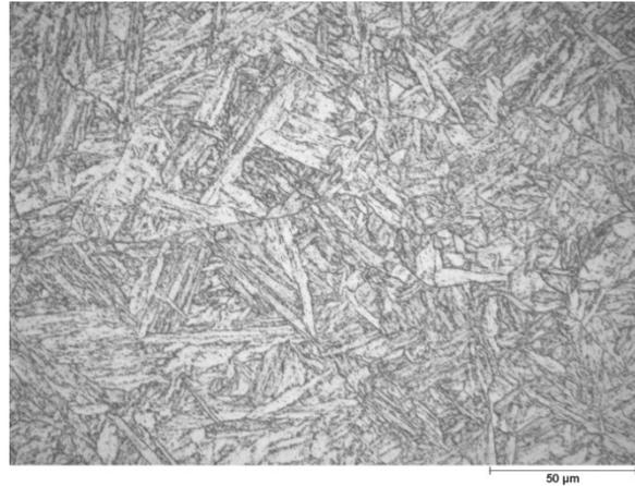
Abbildung 3-5: P91 (Ätzung mit 10 ml Salzsäure, 10 ml Salpetersäure und 1 g Pikrinsäure in 80 ml Ethanol)
