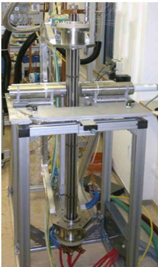
**Bild 7-4:** Testsektion und Kollimatoren für Quelle und Detektor
