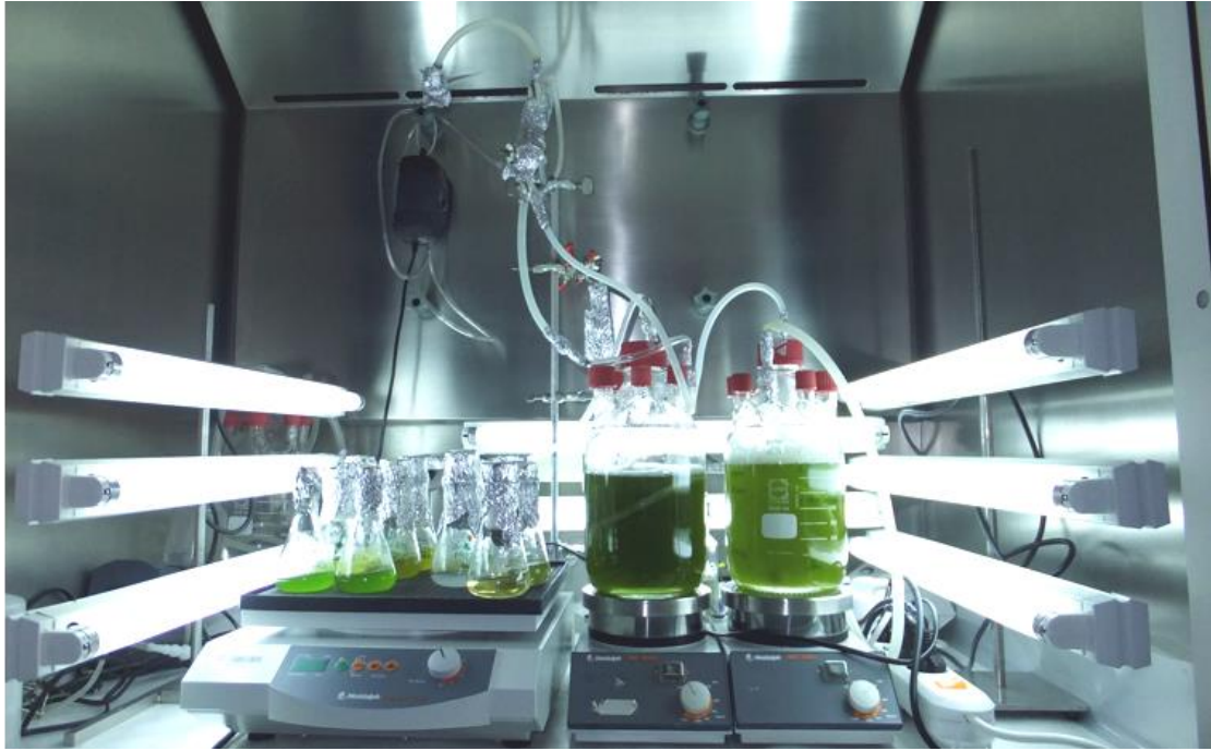
Abbildung 54: Bioreaktoren und Vorkulturen in Erlenmeyerkolben unter der Tageslichtbank
