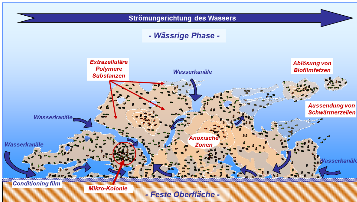
Abbildung 3: Schematische Darstellung der heterogenen Biofilmstruktur, welche geprägt ist durch in die EPS eingebettete Mikrokolonien von Mikroorganismen und einem komplexen Netz an Wasserkanälen.
