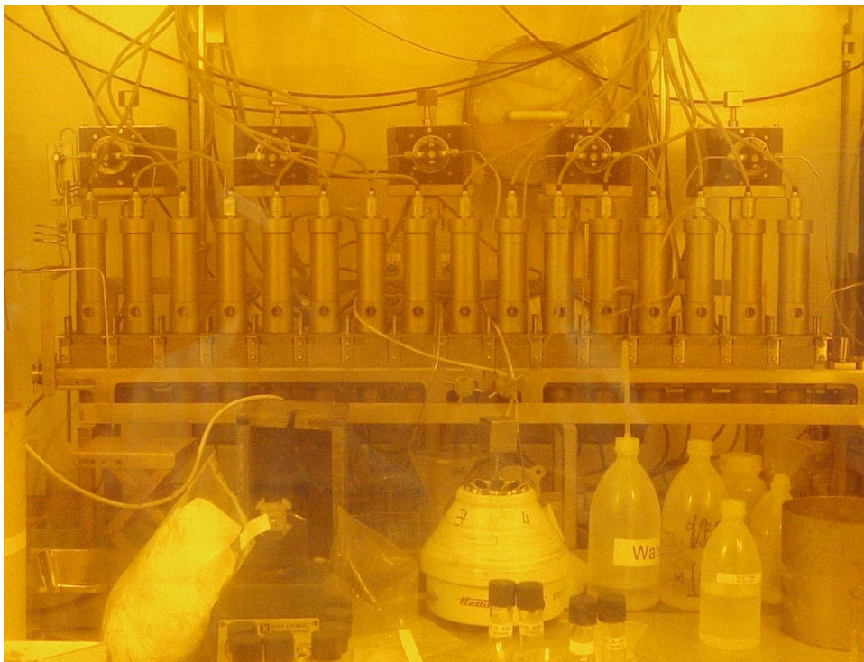
Abbildung 2: Anlage zur Durchführung von hydrometallurgischen Trennprozessen im Labormaßstab in einer Heißen Zelle am JRC-ITU (Institut für Transurane), Foto: JRC-ITU
