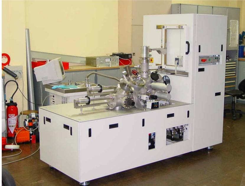
**Bild 2.7:** Atomsonde-Messplatz, Cameca LA-WATAP. Im mittleren Bereich des Aufbaus sind die Vakuumschleusen zum Einbringen der Proben zu erkennen.
