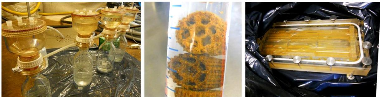
**Abbildung 10: Probenahme der Wasserproben mittels Vakuumfiltration (links), Biofilm-Entnahme der bewachsenen Reaktor-Träger(Mitte) bzw. Flusszellen-Träger (rechts).**
