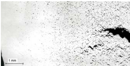
Abb. 4: Ungeätzter Schliff an der Versagensposition; links: Innenseite, rechts: Außenseite; dunkle Punkte sind Kriechporen
