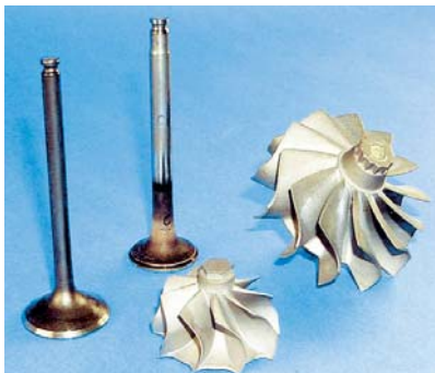
Abb. 6: Ventile und Rotoren aus Titanaluminid (Bild: MTU München)
