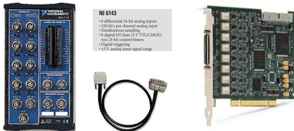
**Abbildung 3.5:** Verwendete Datenerfassungskarte (rechts) mit Zubehör (Anschlussbox, Verbindungskabel)
