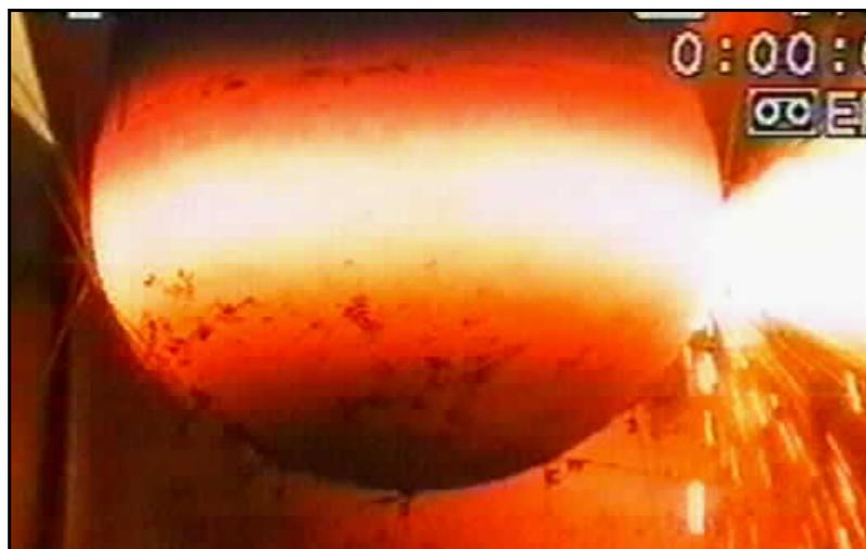
**Bild 5.13:** Aufnahme des Behälters aus EC2 kurz nach Versagen und Beginn des Schmelzeaustritts.
