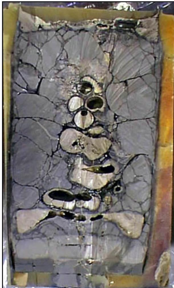
**Bild 3.3:** Schnitt durch die erstarrte Schmelze und den Tiegel des MASCA-RCW1-Experiments.
